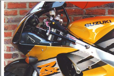
1/ Monter la bride de fourche sur le canon gauche. Positionner la bride de fourche afin d'avoir une distance de 93 mm entre le Té de fourche inférieur et la bride de fourche.
