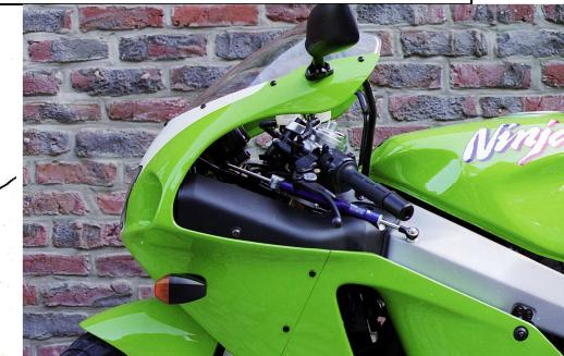
1/ Monter la bride de fourche sur le canon gauche. Positionner la bride de fourche afin d'avoir une distance de 79 mm entre le Té de fourche inférieur et la bride de fourche.
