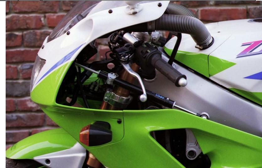
1/ Monter la bride de fourche sur le canon gauche. Positionner la bride de fourche afin d'avoir une distance de 28 mm entre le Té de fourche inférieur et la bride de fourche.
