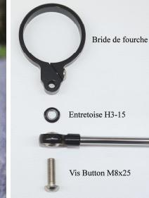
1/ Monter la bride de fourche sur le canon gauche. Positionner la bride de fourche afin d'avoir une distance de 105 mm entre le Té de fourche inférieur et la bride de fourche.
