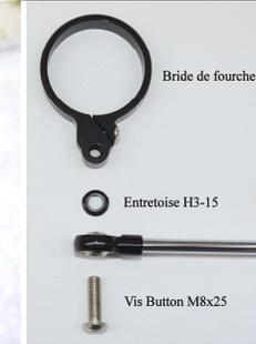
1/ Monter la bride de fourche sur le canon gauche. Positionner la bride de fourche afin d'avoir une distance de 90 mm entre le Té de fourche inférieur et la bride de fourche.
