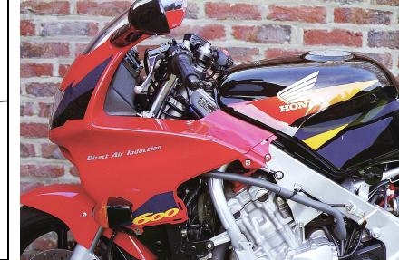
1/ Démonter le flanc de selle et carénage du côté gauche. Enlever le conduit de la prise d'air fixée sur le flanc de carénage.
