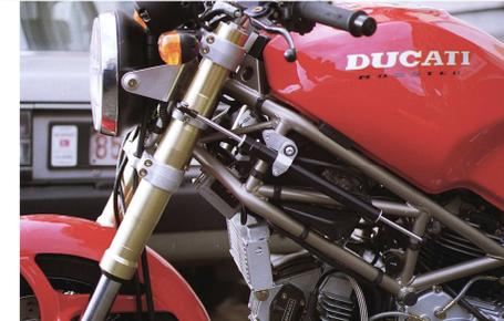
1/ Monter la bride de fourche sur le canon gauche. Positionner la bride de fourche afin d'avoir une distance de 33,00 mm entre le Té de fourche inférieur et la bride de fourche.
