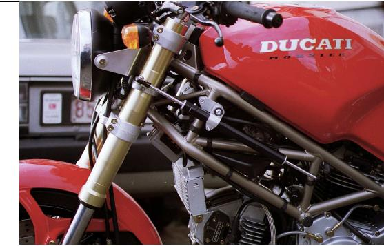
1/ Monter la bride de fourche sur le canon gauche. Positionner la bride de fourche afin d'avoir une distance de 75 mm entre le Té de fourche inférieur et la bride de fourche.
