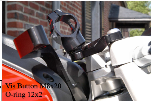
Patte 696 Monster Vis tête cylindrique M6x65
